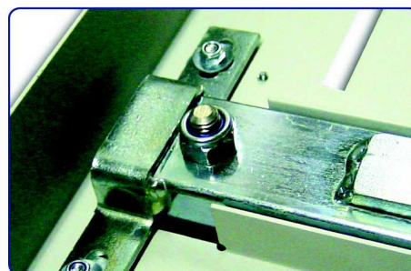
Биговащ механизъм с възможност за настройка на натиска върху хартията.
